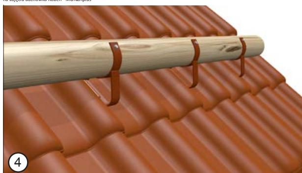
Po przymocowaniu wymaganej ilości uchwytów D należy zamontować bal przeciwniegowy. Ostatnim etapem jest sprawdzenie poprawności wykonanego montażu, a w szczególności stabilności wszystkich połączeń mechanicznych.
