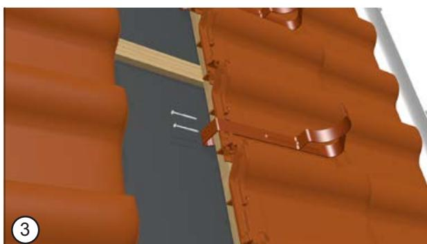
W przypadku uchwytów D nie ma konieczności przykręcania dodatkowej łańcuchowej. Uchwyt D należy zahaczyć za tą samą lątkę, na której opiera się dachówka oraz przykroić za pomocą za pomocą wkrętów Ø8 mm.
